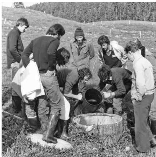
Coloration pour traçage des cours d'eau souterrains.
