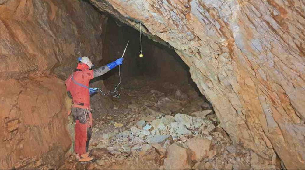
Mesures de la vitesse du courant d'air et de la température dans la galerie d'entrée de la grotte. Le courant d'air est estimé à près de 30 m<sup>3</sup>/s. Le bonnet est vivement conseillé !
